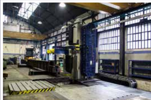
ALESATRICE A MONTANTE MOBILE MECOF corsent 18,300 x 2750 mt portata 300 qt diametro 3,300 mt con tavola rototraslante portata 30 t
